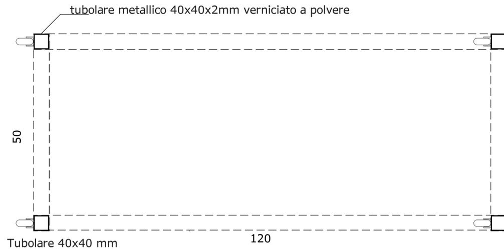
fissaggio degli elementi con saldature a filo con smerigliatura dei cordoni di saldatura con smerigliatore assiale
